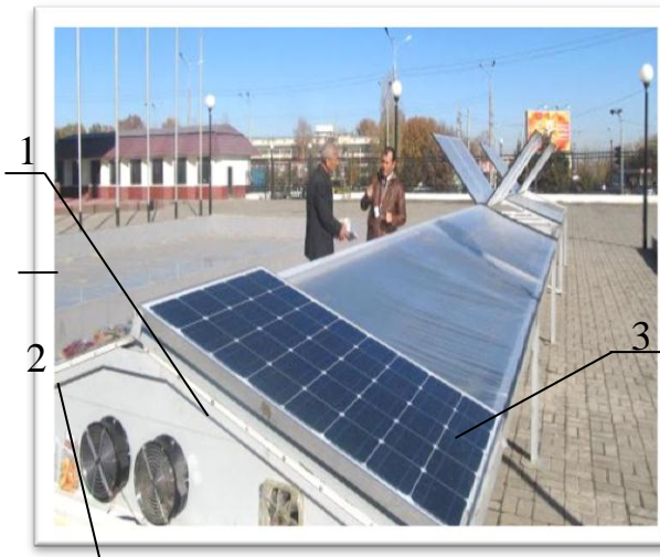
Рис 1. Сушильная установка под пленочным покрытием с использованием солнечной батареи 1-солнечная батарея; 2-вентилятор; 3-пленка
